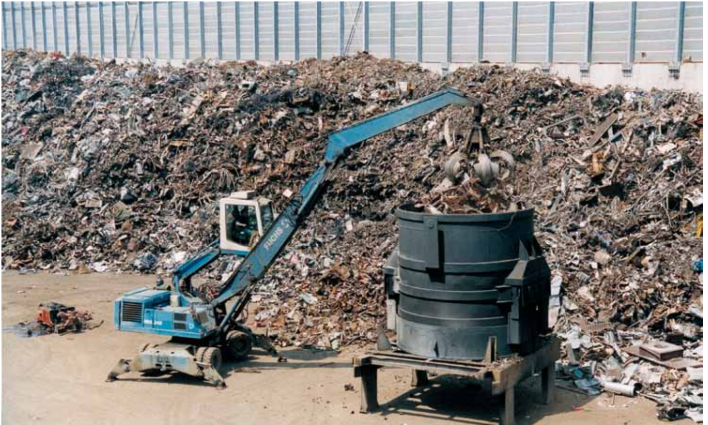
Parco rottami – preparazione caricamento cesta
