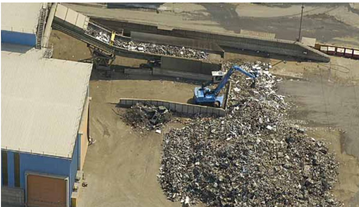
Rottame in fase di caricamento all'addensatore
