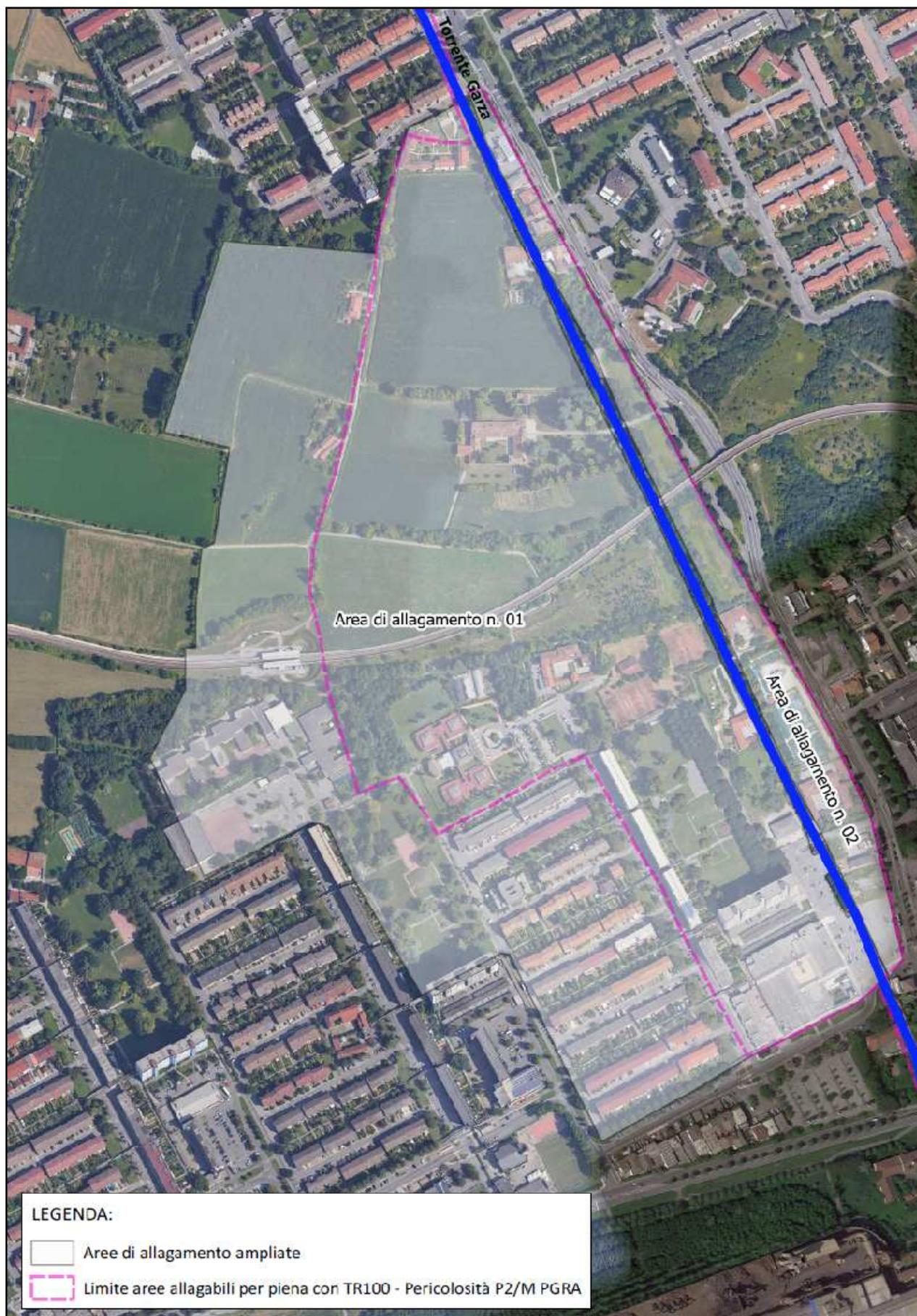
In entrambi i casi, gli ampliamenti derivano dall'utilizzo, nel modello di calcolo, del rilievo LiDAR, i cui dati forniscono una dettagliata ed aggiornata configurazione piano altimetrica del suolo, e dagli accertamenti sopralluogo.
