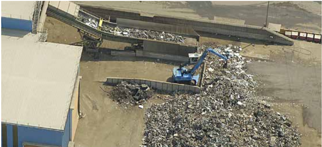
Rottame in fase di caricamento al frantumatore
