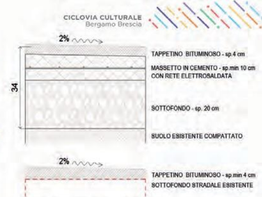
Pacchetti di pavimentazione | scala 1:10
