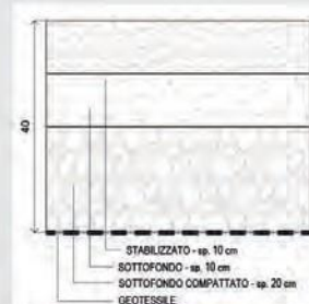
Pavimentazione in stabilizzato | scala 1:10
