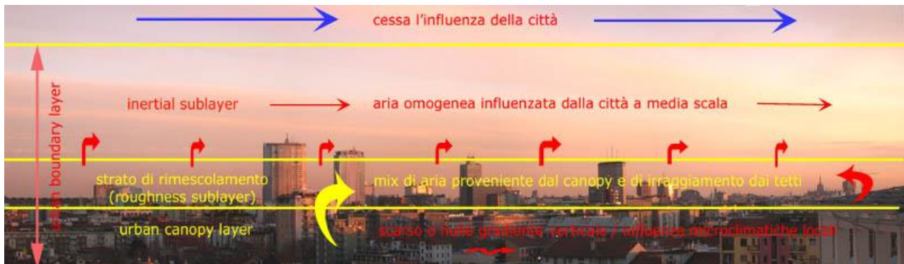
Figura 107: Schema degli strati (“layers”) che costituiscono l’atmosfera urbana (urban boundary layer),
