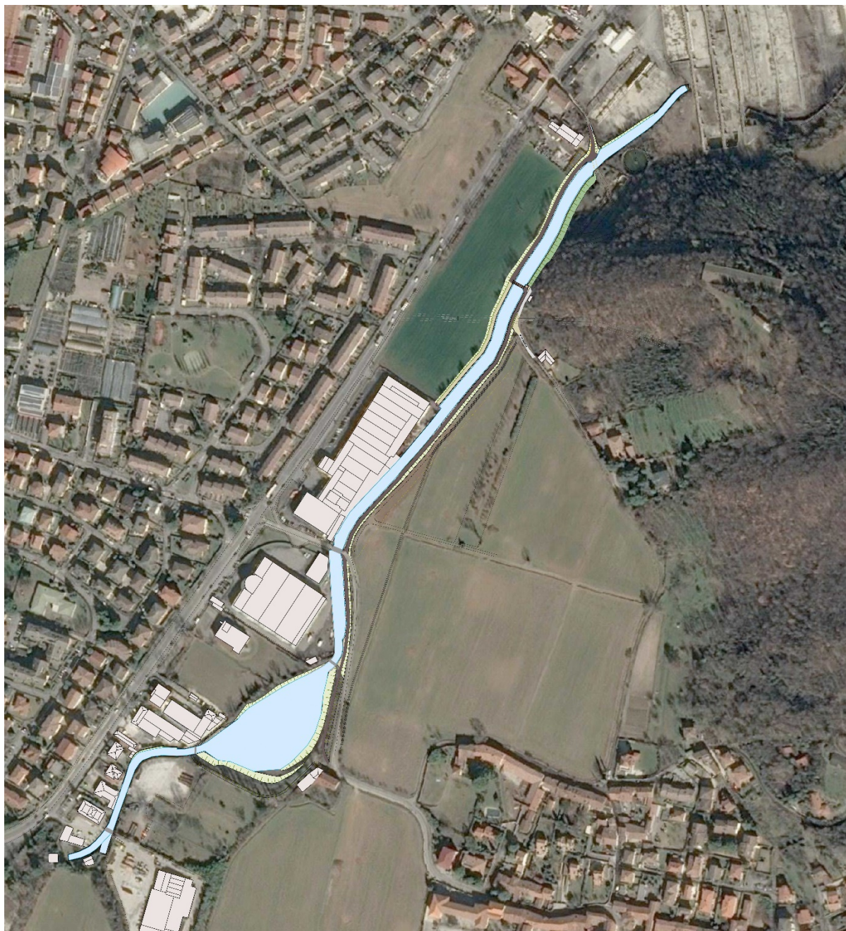
Figura 5-2: Planimetria area d'intervento con indicazione della quota idrica massima al passaggio della piena di progetto.
