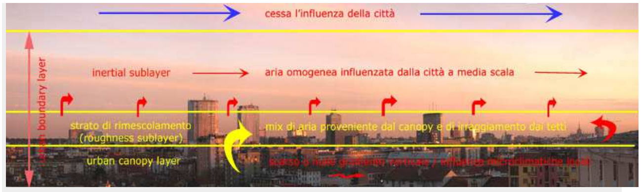
Figura 21: Schema degli strati che costituiscono l'atmosfera urbana (urban boundary layer)
