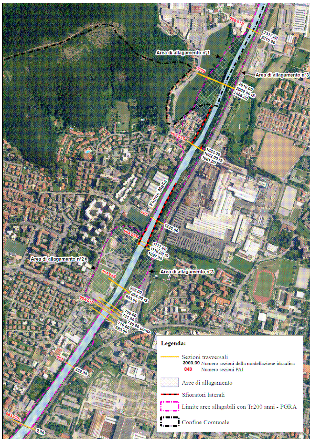
Figura n°4.2.1.1 - Planimetria del modello geometrico di calcolo - Fiume Mella
