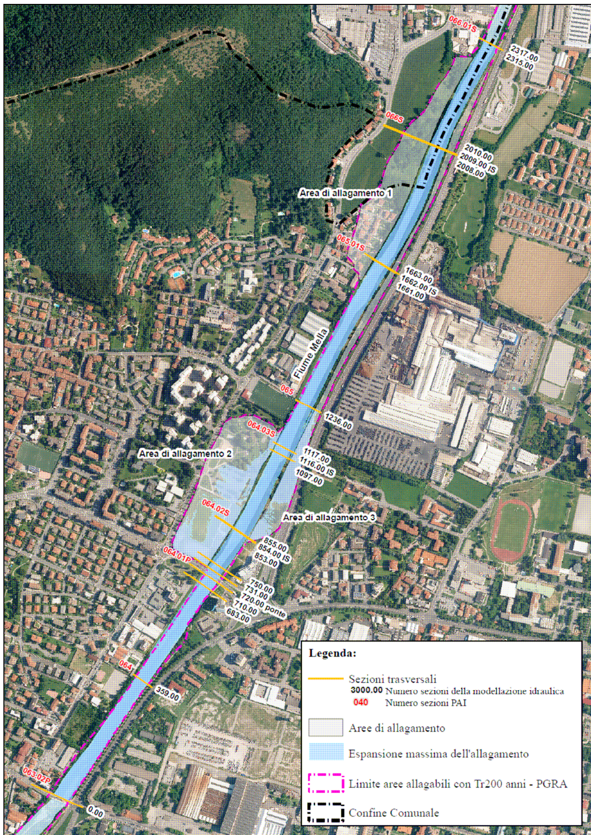
Figura n°4.5.2 - Planimetria dell'espansione massima dell'allagamento
