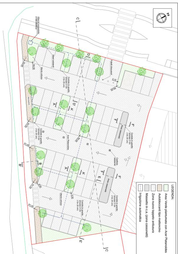
PLANIMETRIA STATO DI PROGETTO: disposizione parcheggio - scala 1:200
