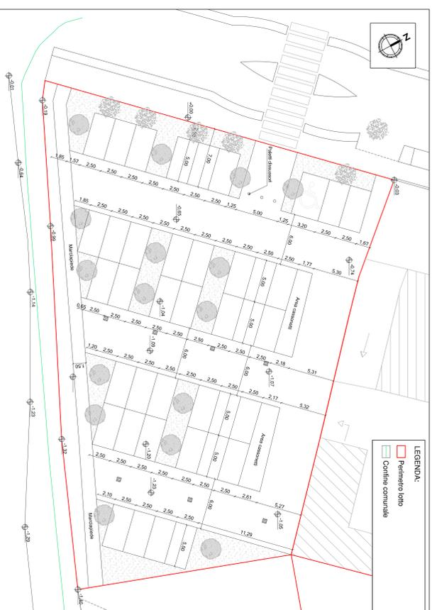
PLANIMETRIA STATO DI PROGETTO: segnaletica orizzontale e verticale - scala 1:200
