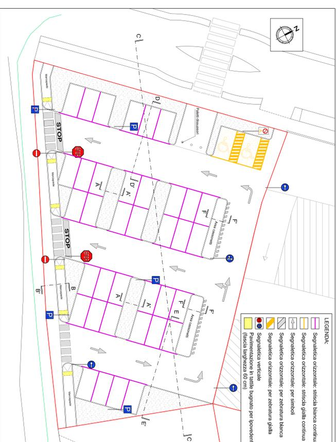
PLANIMETRIA STATO DI PROGETTO: disposizione parcheggio - scala 1:200
