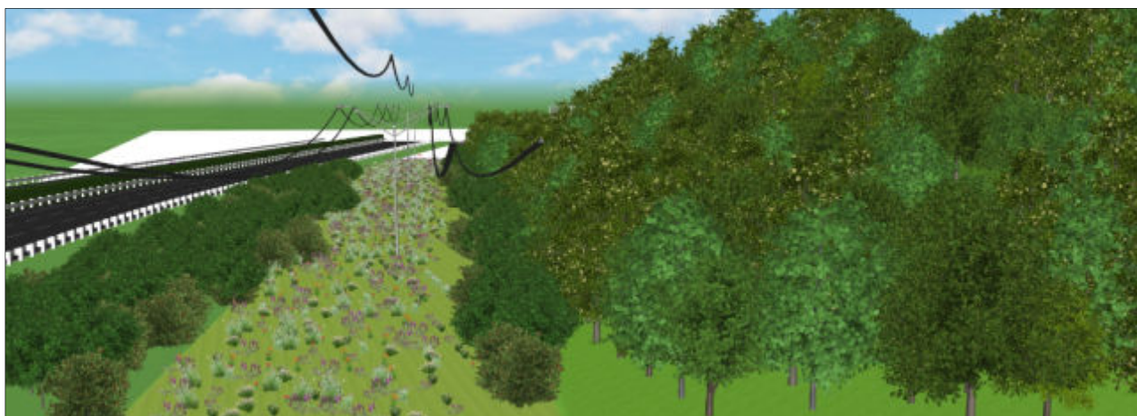
Fig. 17: Dettaglio area interessata dalla fascia arbustiva seguita dal prato fiorito e dal bosco con sviluppo graduale dell'altezza
