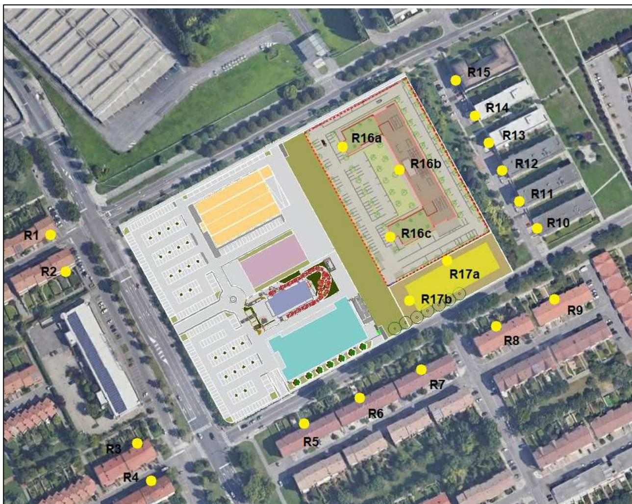
Figura 15 - Posizionamento dei recettori e dei punti sul confine.
