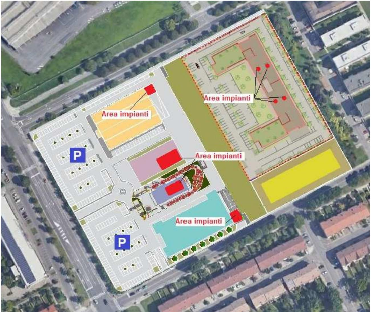
*Figura 9 – Stato di progetto, planimetria con ubicazione delle unità esterne sorgenti di rumore.*
