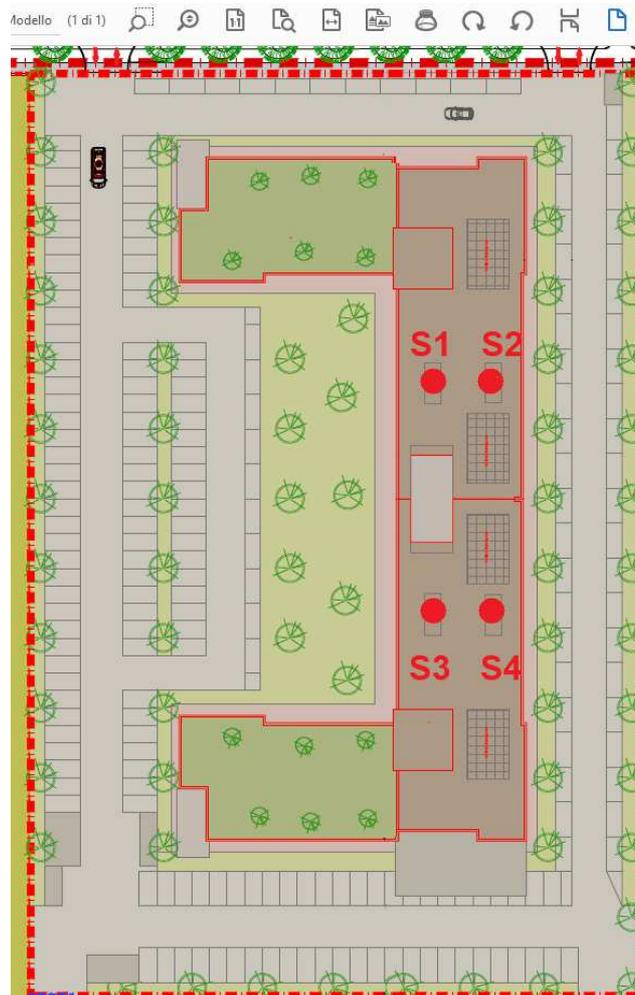
*Figura 14 – Stato di progetto, planimetria con pianta copertura e ubicazione delle unità esterne sorgenti di rumore.*
