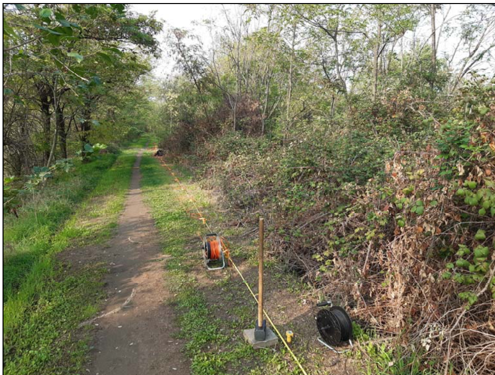
INDAGINE LINEARE DI SISMICA ATTIVA (MASW2 - lato Brescia)
