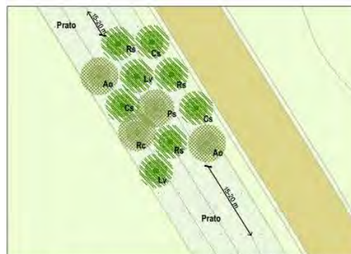
INTERVENTO 13 Rinverdimento rilevato in zona antistante il ponte
