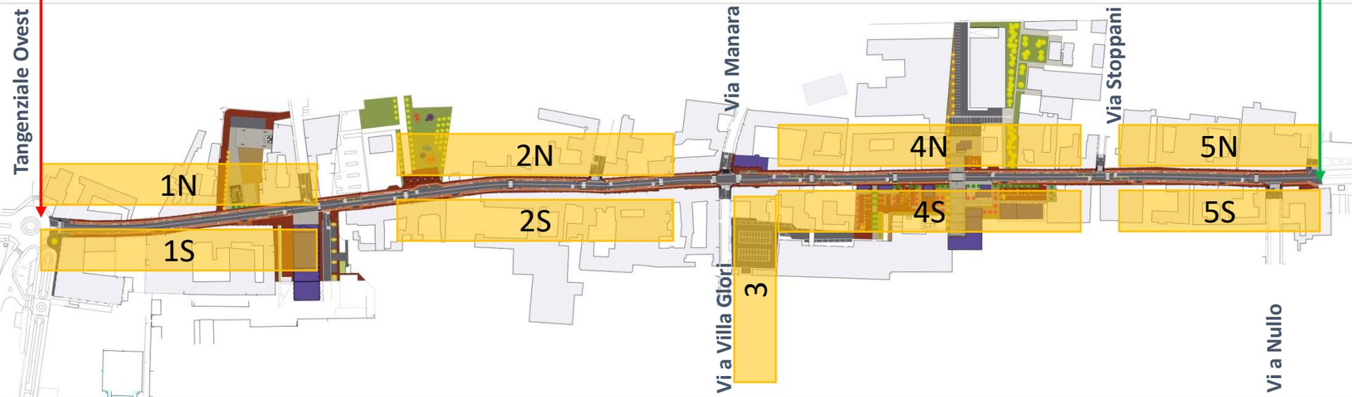
Lavori di riqualificazione su semicarreggiata con il mantenimento di un senso di marcia
