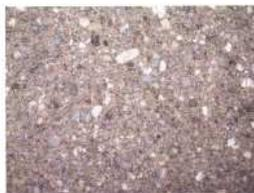
Il colore d'insieme risulta brunoastro per la probabile presenza nell'impasto di un elevato tenore di argilla; la superficie è scabra e porosa e le cariche sono scarsamente classate con presenza di piccoli ciottoli. Le qualità meccaniche dell'intonaco risultano del tutto inadeguate; la decoesione diffusa lo rende friabile al tatto; l'adesione al substrato è quasi ovunque carente, segnalata da distacchi, deformazioni e cadute.
