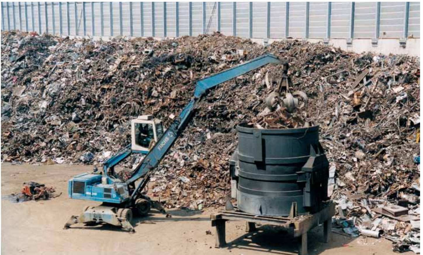
Parco rottami – preparazione caricamento cesta
