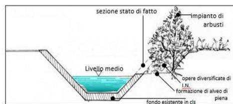
SEZIONE TIPO: RINATURALIZZAZIONE CANALE SU UNA SOLA SPONDA
