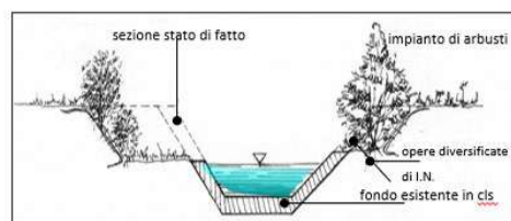
SEZIONE TIPO: RINATURALIZZAZIONE CANALE SU DUE SPONDE
