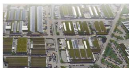
Fotosimulazione interventi diffusi in applicazione di SuDS e NBS nell'area industriale di Sesto Uteriano. Fonte: Masterplan degli interventi di drenaggio urbano e gestione delle acque meteoriche nelle aree produttive, a valle della verifica della criticità e delle possibili soluzioni. Progetto pilota per l'area del Sud Est Milano (cod. GEN17006) Committente: Polis-Lombardia - Istituto regionale per il supporto alle politiche della Lombardia - Raggruppamento: RTP Studio Meione - Indre - Gibelli.
