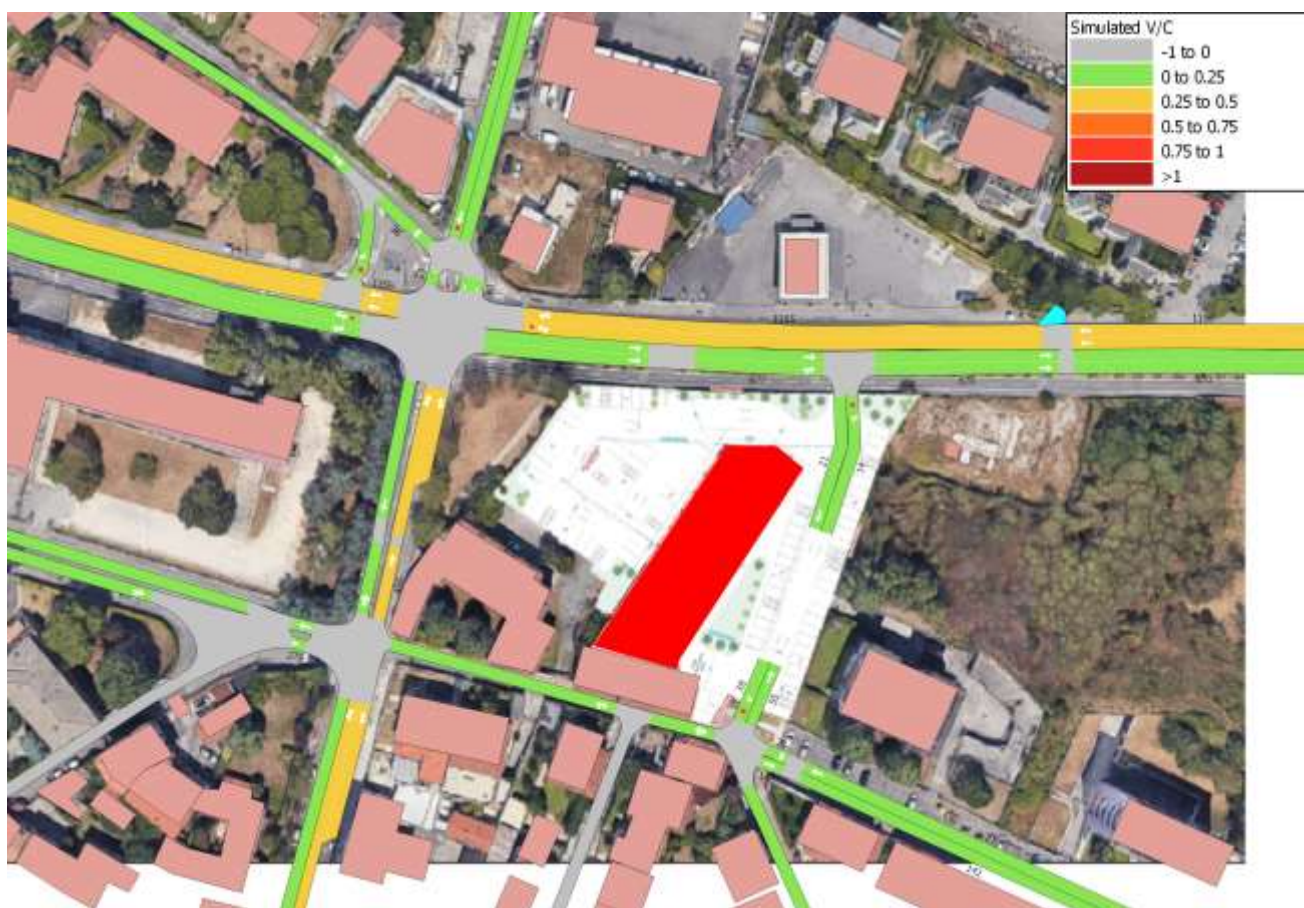
Figura 36 – Scenario di progetto: flussogramma rete stradale area di studio
