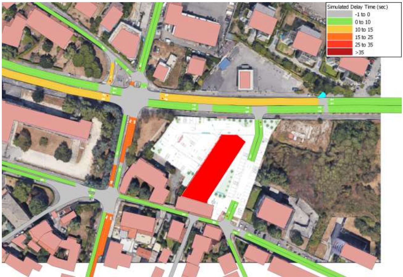
Figura 38 – Scenario di progetto: perditempo medio veicolare rete stradale area di studio
