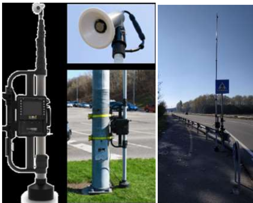
Figura 13 – Strumentazione video con palo telescopico
