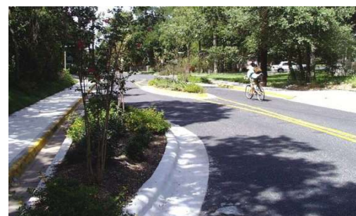
Esempio di chi-cane con aiuole vegetate integrate al sedime stradale
