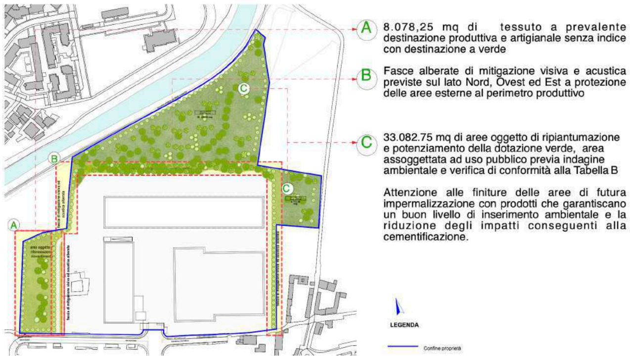
Immagine 9: Schema sintetico delle opere di mitigazione interne al comparto
