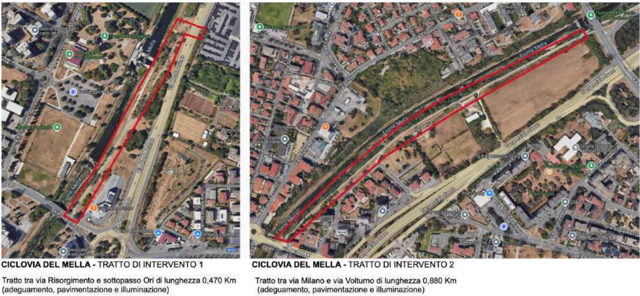
Immagine 11: Schema sintetico delle opere di mitigazione esterne al comparto
