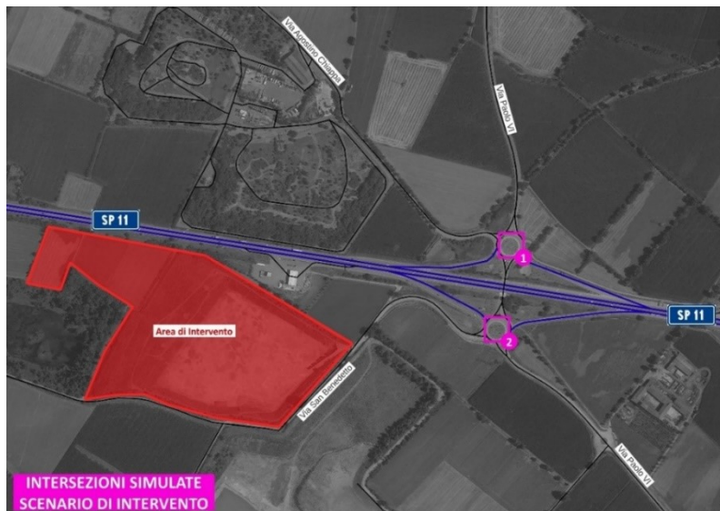
Figura 55 – Scenario di Intervento – Intersezioni simulate con il modello di microsimulazione VISSIM
