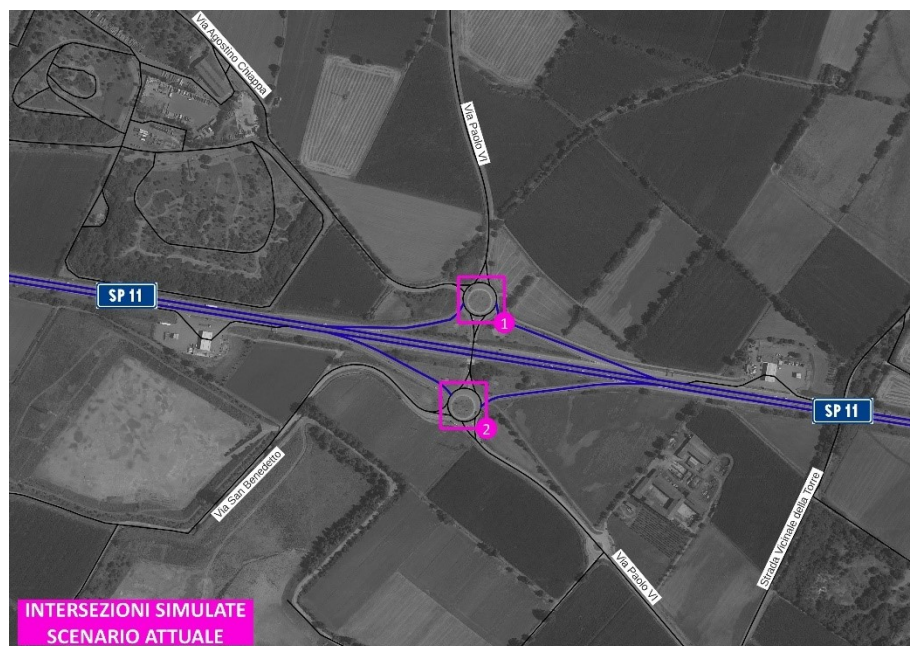
Figura 53 – Scenario Attuale – Intersezioni simulate con il modello di microsimulazione VISSIM
